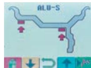
Programmes ALU S et PAX automatiques Programa ALU S y PAX automático Automatic ALU and PAX programs
